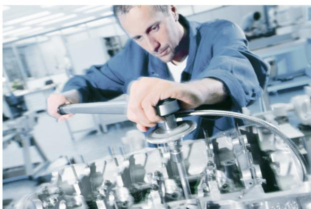
Außerdem müssen neue Zylinderkopfschrauben nach den entwickelten Anziehverfahren und Anziehreihenfolgen der Motoren- und Dichtungshersteller eingeschraubt werden. Der Anzug mit Drehmoment und Drehwinkel führt zu einer gezielten Ausnutzung der Schraubencharakteristik, wobei sehr kleine Schraubenkraftdifferenzen erreicht werden. Die Schrauben werden
