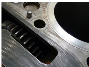
Уплотняемые поверхности моторного блока с цилиндрическим зубчатым колесом
