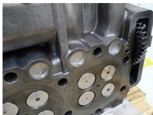
Уплотняемая поверхность ГБЦ с цилиндрическим зубчатым колесом
